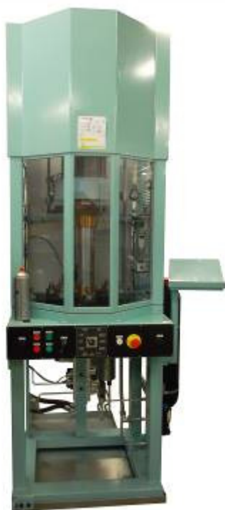
JUS na narážení hřídelí – vlastní výroba
