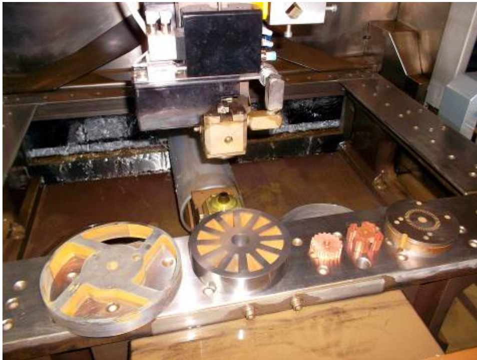
Drátová řezačka SODICK SLC600G Premium – příklady použití výroby komponentů
