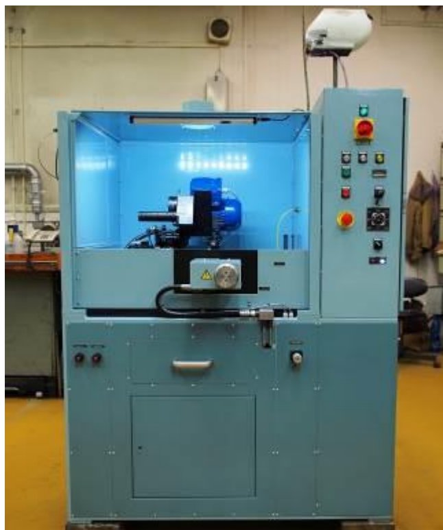
Stroj na soustružení komutátorů vlastní výroby
